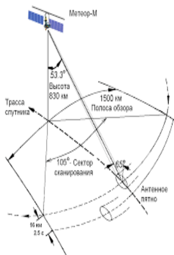
Рис. 3. Примерный ход лучей при микроволновом зондировании с Метеора-М с высоты 830 км и ширине обзора в 1500 км.
